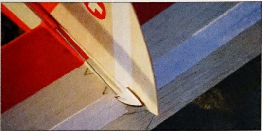
Ein Scharnier zwischen Leitwerk und Ruder haben wir in der Praxis durch ein funktionelles Klebefilm-Scharnier ausgetauscht
