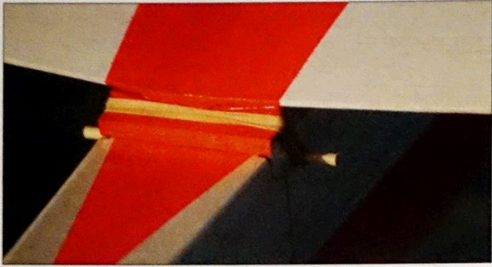
Da vorne eine Sperrholznase in den Hauptspant greift, reicht hinten ein einziger Gummiring für die Befestigung der Flächen
